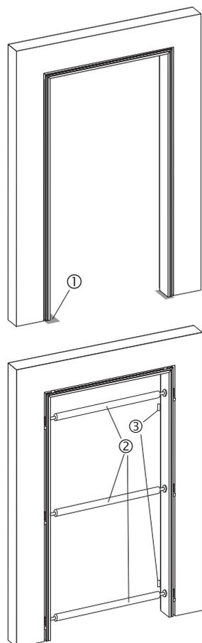
Stellen Sie das zusammengebaute Futterteil nach dem Aushärten des Gehrungsleimes - ohne Gehrungsbelastung - in die Wandöffnung. Um Feuchtschäden an Türzargen durch Feuchtigkeitseinwirkungen oder Putzwasser im Bodenanschlussbereich zu vermeiden ( wie z.B. in Bad und Küche ), sollten Sie die Zarge mit wasserabweisenden Werkstoffen (1) unterlegen.
