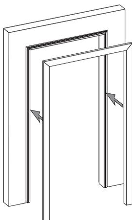
Geben Sie nun zur Befestigung der Zierbekleidung auf der Rückseite des Türfutters punktweise Weißleim in die Längs- und Quernut, und schieben Sie die Zierbekleidung auf. Durch leichte Schläge mit der Hand (oder einem Gummihammer) wird die Zierbekleidung endgültig fixiert. Abschließend versiegeln Sie die Anschlussfuge Zarge - Boden dauerelastisch (9).
