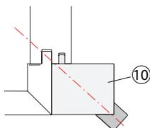
Unsichtbare Befestigung z.B. durch: Distanzmontageschraube ( Toproc-Schraube ) unter der Dichtung, Telleranker, Mauerklammern
